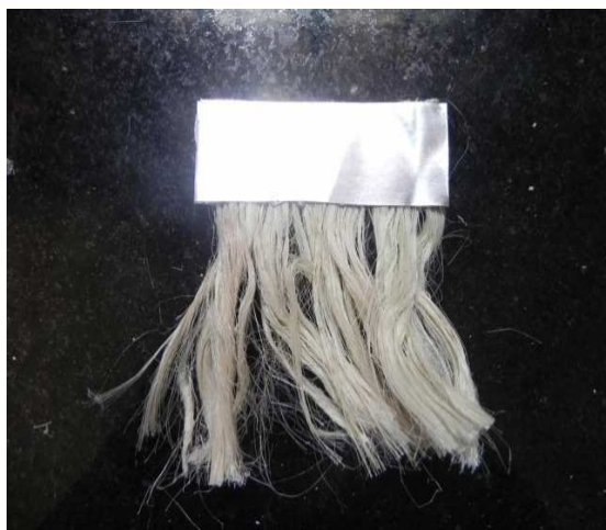
Figura 3 - Fibra colada na placa de alumínio.
