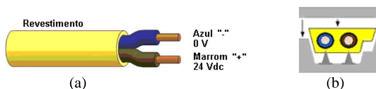
Figura 4: a) Condutores em um cabo padrão do barramento AS-I; b) Esquema de conexão.
