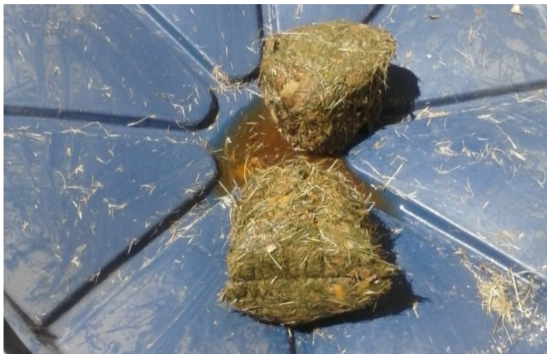
Fotos 7: Resíduos Sólidos retirados do Biodigestor
