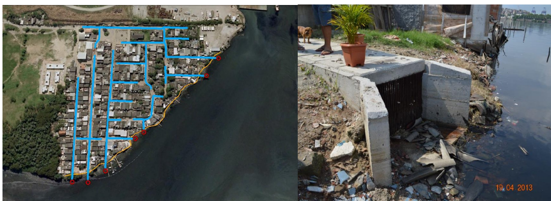
Foto 4: Disposição da Rede de Drenagem
