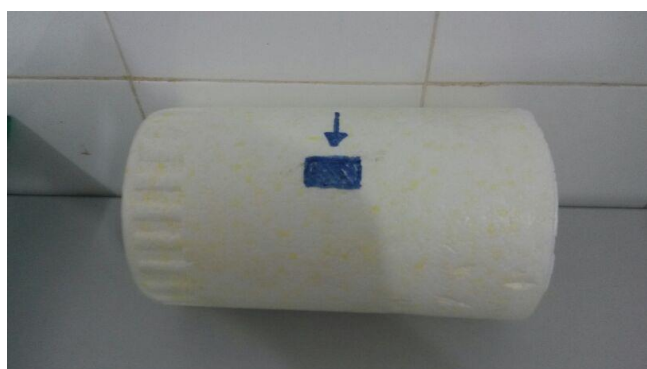
Figura 2- Local do corte para o servo motor
