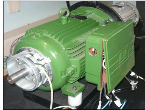
Figura 7 – Foto do Protótipo do GRV de 5kW 6x4
