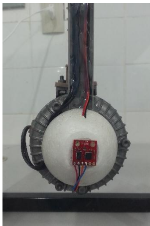
Figura 5: Acelerômetro acoplado ao motor.
