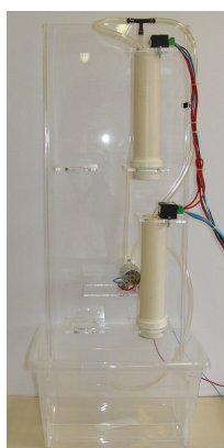
Figura 2. Sistemas de dois tanques acoplados.
