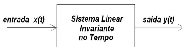
Figura 1 – Diagrama de um sistema LIT SISO de tempo contínuo.
