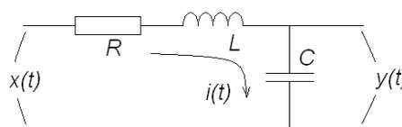
Figura 4 – Circuito elétrico passivo com resistor, indutor e capacitor para exemplificar um SLIT de tempo contínuo.
