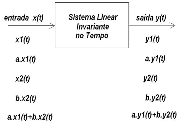
Figura 2 – Propriedade de Linearidade de um sistema LIT SISO de tempo contínuo.
