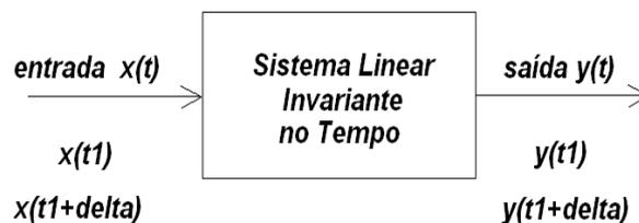
Figura 3 – Propriedade de Invariância no tempo de um sistema LIT SISO de tempo contínuo.
