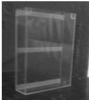
Figura 12. Tanque retangular de acrílico.
