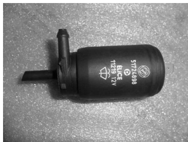
Figura 14. Bomba de esguicho de carro. Tensão de Funcionamento 2 a 12 Volts.
