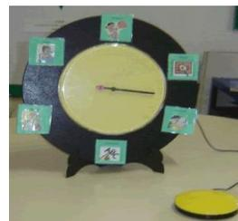
Figura 2 – Comunicador artesanal, modelo relógio com acionador acoplado.
