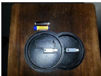
Figura 11 – Acionador duplo, wireless em construção.
