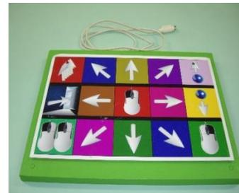
Figura 6 – Mouse adaptado com várias funções.
