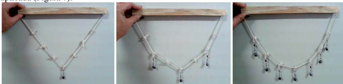
Figura 7 – Variação das cargas aplicadas em um cabo.
