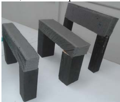
Figura 3 – Modelos em espuma de viga com variação da seção transversal.
