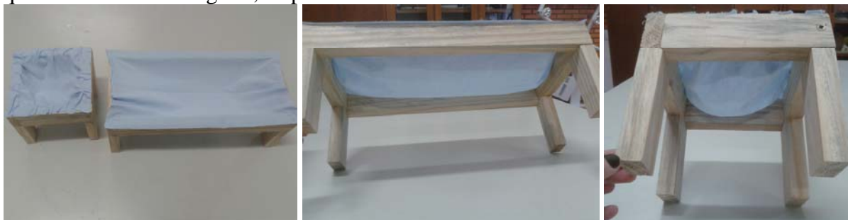
Figura 5 – Modelos em EVA de duas formas de conceber uma sacada em balanço.
