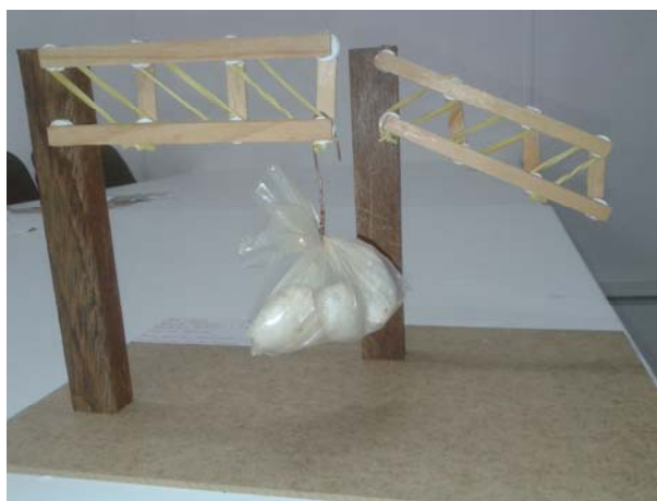
Figura 1 – Modelo de treliça com variação da direção das diagonais.
