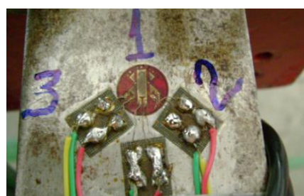
Figura 6 - Circuito Modelo de Strain Gages aplicado.
