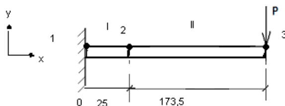
Figura 10 – Elemento de viga sob flexão.
