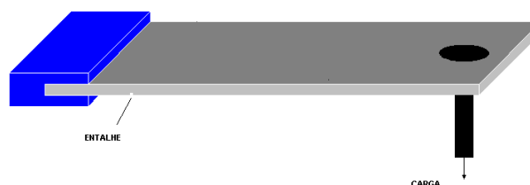
Figura 1- Carregamento de uma viga com entalhe.
