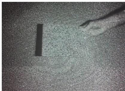
Figura 4. Deslocamento dos pontos da malha infravermelha projetada pelo Kinect
