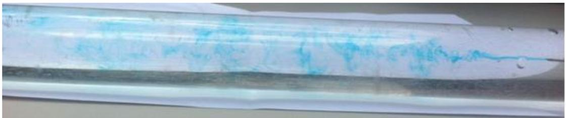
Figura 6 - Ensaio 4: Perfil Turbulento
