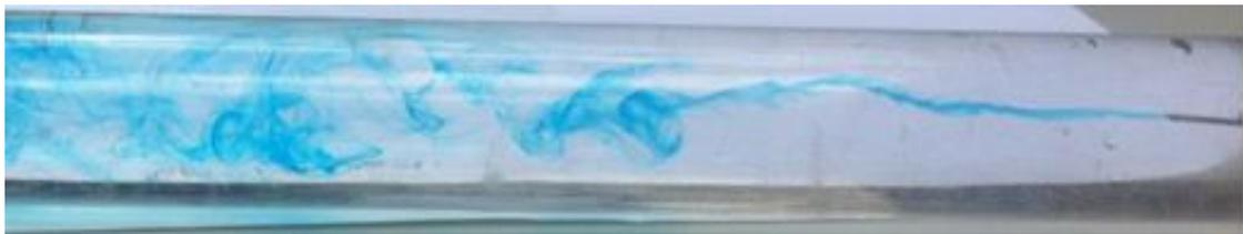
Figura 5 - Ensaio 3: Perfil Transitório
