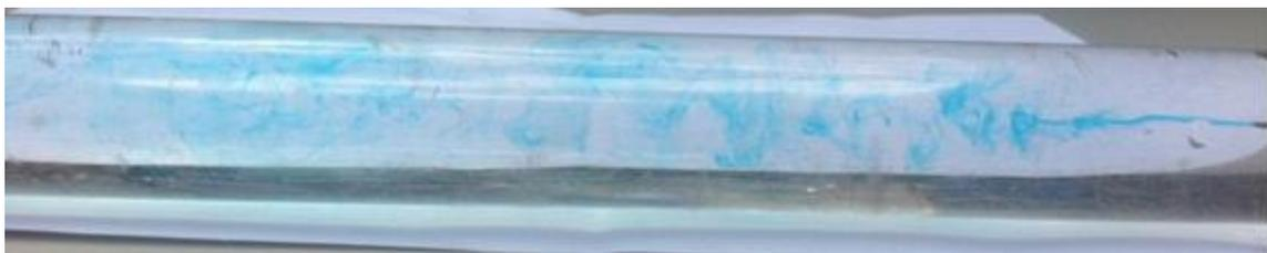
Figura 7 - Ensaio 5: Perfil Turbulento
