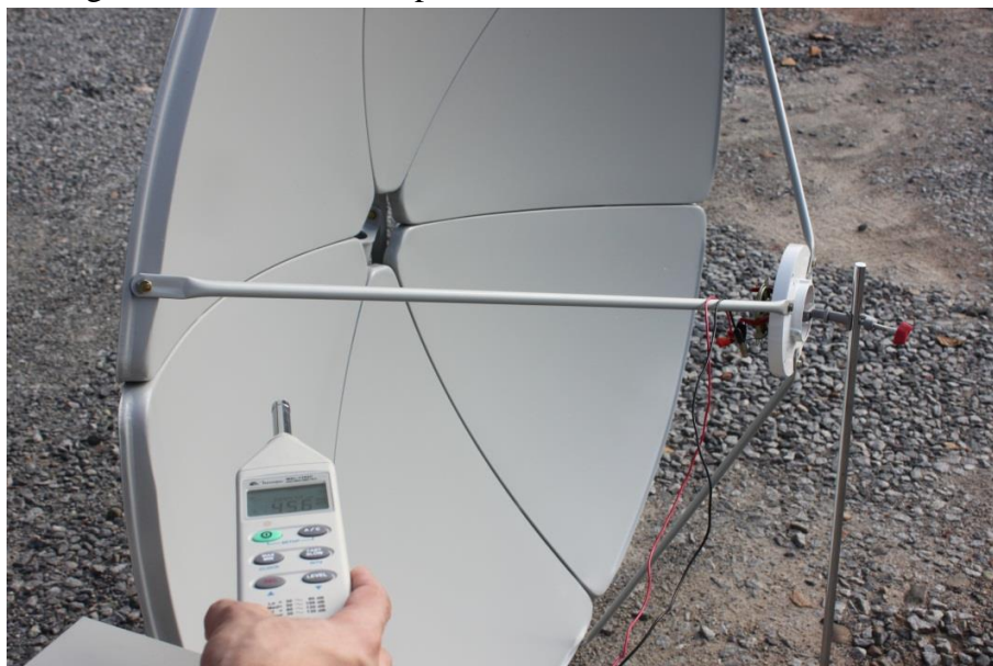
Figura 3 - Decibelímetro posicionado ao lado da fonte emissora
