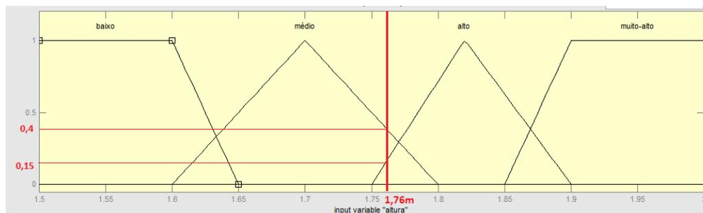
Figura 8 – Representação da função de pertinência de entrada (altura).
