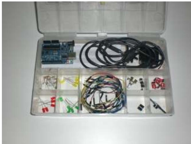
Figura 01 – Kit de arduino básico.
