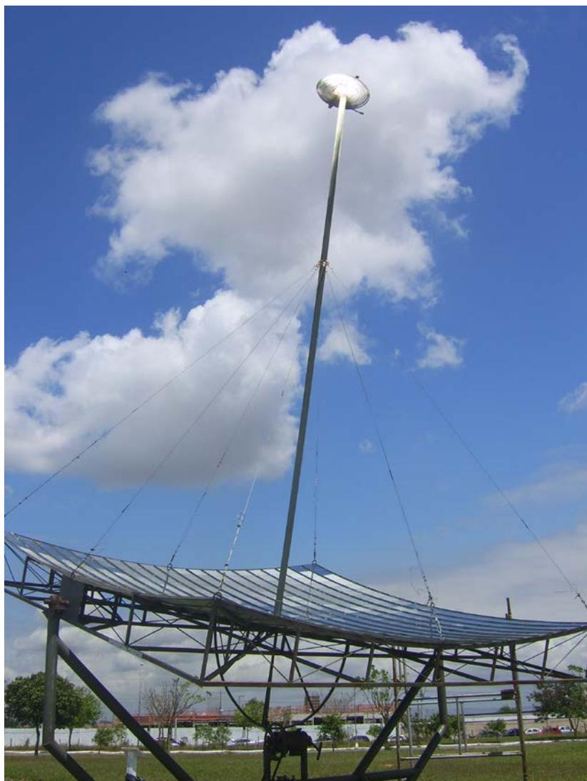
Figura 3 - Protótipo do vaporizador solar.
