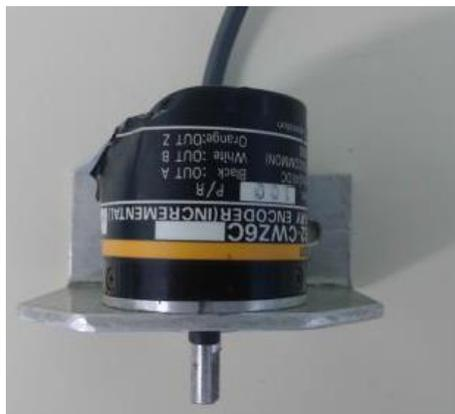
Figura 6 – Encoder utilizado com um flange integrado.
