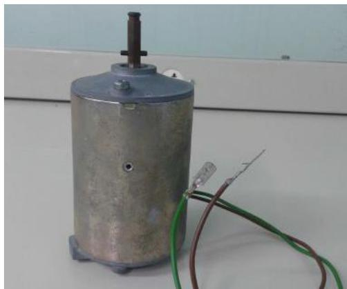
**Figura 4** – Motor DC 24 V usado na planta didática.
