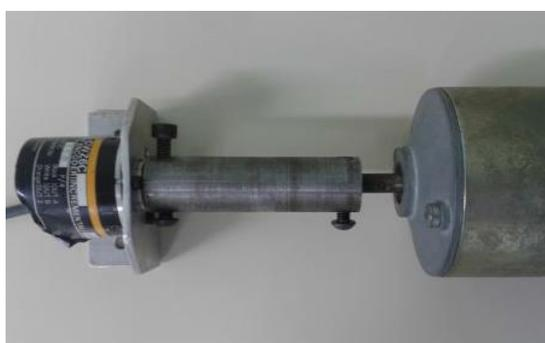
**Figura 11** – Conjunto motor / carga / encoder.
