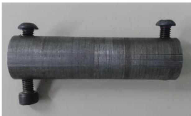
**Figura 5** – Acoplamento de aço carbono 1020 usado como carga.
