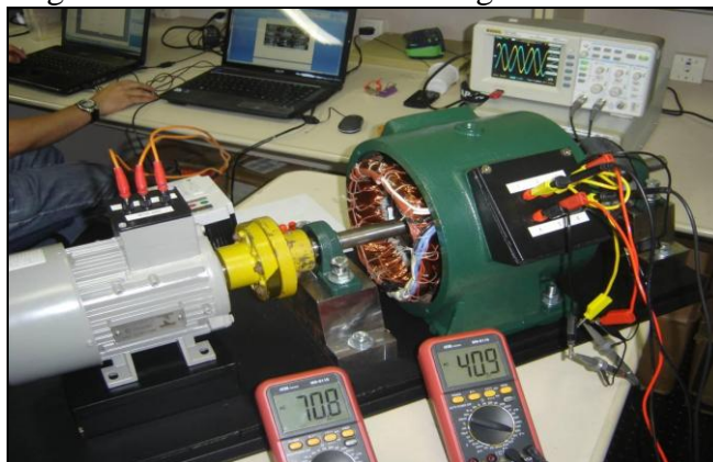
Figura 6 – Teste em bancada do gerador síncrono
