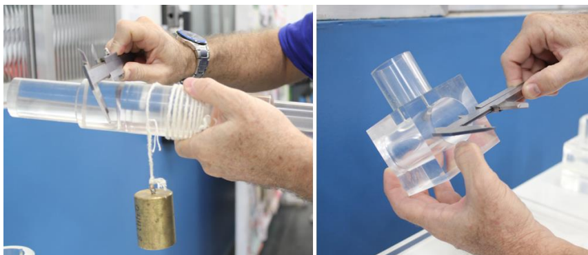
Figura 3 – Medições no eixo e mancais.
