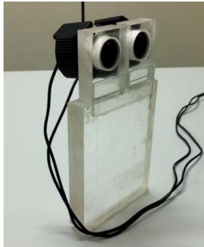
Figura 8: Suporte em acrílico para instalação de duas web cams com linhas de visão paralelas.
