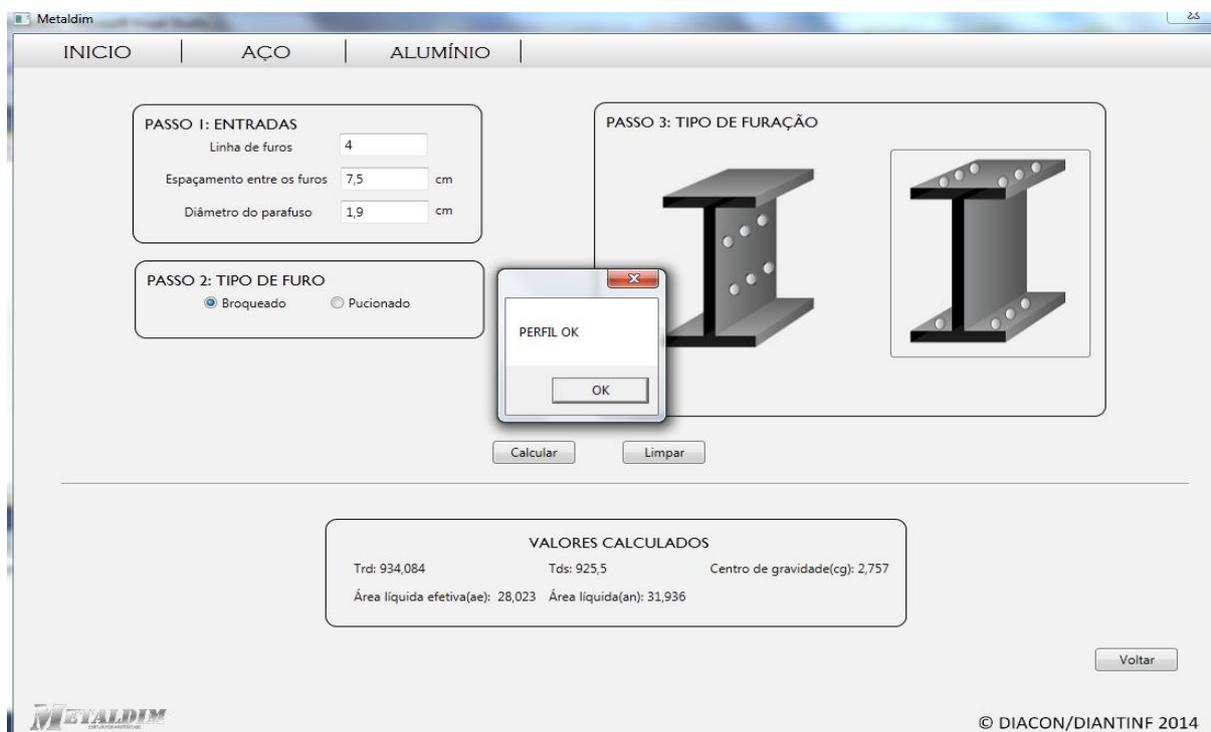
**Figura 3** – Verificação do perfil I soldado (módulo de tração).
