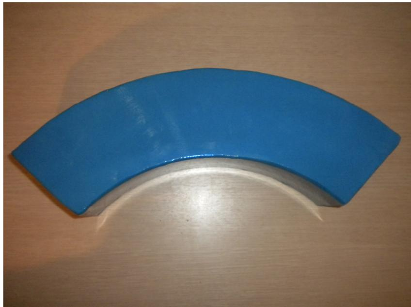
Figura 4: Sólido geométrico feito com Aço 1020.
