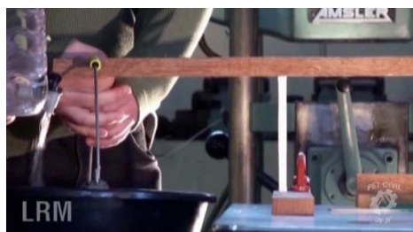
Figura 1: Ensaio de compressão em corpo de prova de papel
