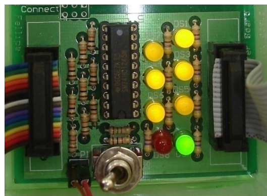
Figura 6 – CI SN74HCT245N usado como driver para acionamento das chaves.
