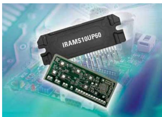
Figura 3 – Módulo IGBT IRAMS10UP60A integrado. Fonte (Datasheet International Rectifier).
