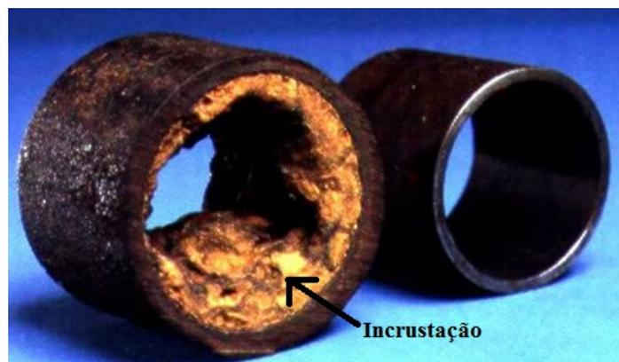
Figura 1: Fotografia da incrustação em um tubo de caldeira aquatubular.
