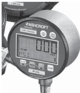
Figura 7: Representação do sensor de pressão da marca *Ashcroft* modelo 2274 XAO.
