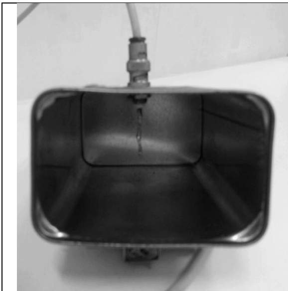
Fig. 2. Monopolo transmissor dentro do guia
