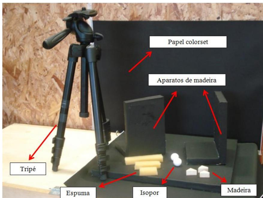
Figura 2 – Aparato instrumental e materiais utilizados na montagem dos modelos qualitativos.
