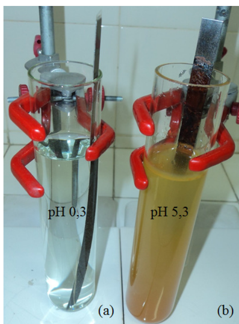
Figura 2 - Ensaio de corrosão no início (a) e após uma semana (b).
