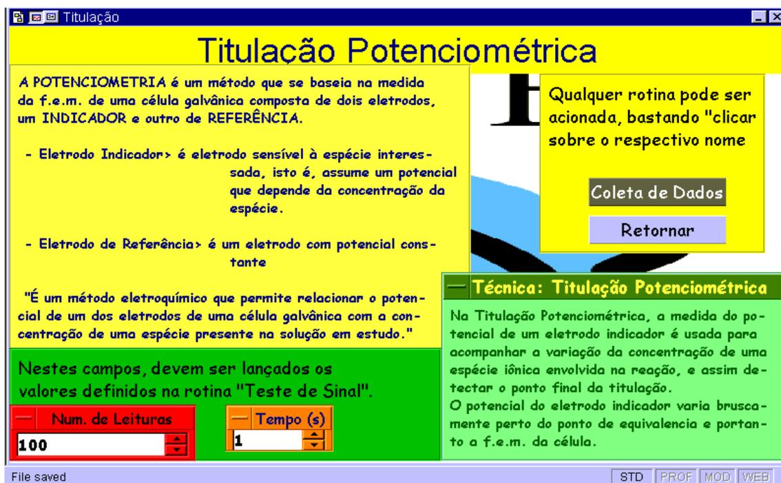
Figura 7. Apresenta o método titulométrico de análise química. Observa-se os campos destinados à vinculação dos dados obtidos na rotina "Teste de Sinal", assim como dispara a rotina da coleta dos dados titulométricos.
