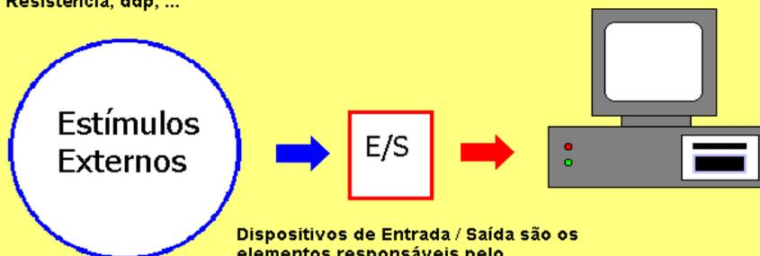
Dispositivos de Entrada / Saída são os elementos responsáveis pelo interfaceamento do Computador com os estímulos externos. São os condicionadores de sinal, conversores A/D e D/A, Placas de Aquisição de Dados, além dos blocos de conexões elétricas.
