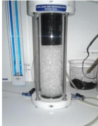
Figura 2 – Coluna de Adsorção Sólido-Gás Adaptada para Processamento Sólido-Líquido
