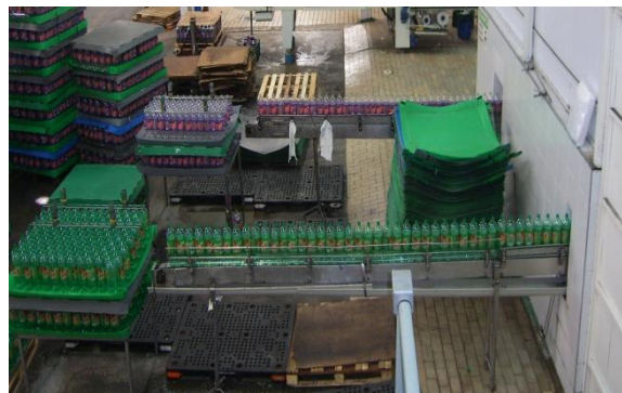
Figura 2 – Garrafas em correia transportadora em direção a um pallet; Fonte: Basic of Sensors – Siemens
