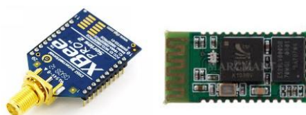
Figura 5 – Módulos Bluetooth e Zigbee usados para Comunicação.
