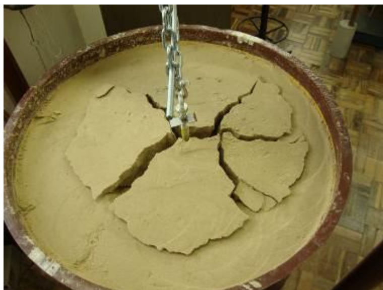
Figura 10 - Superfície de ruptura ao final do ensaio
