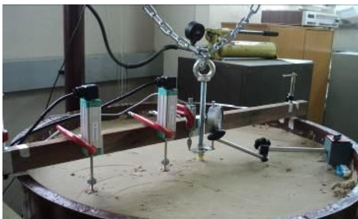
Figura 5- Instalação dos transdutores de deslocamento
