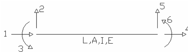
Figura 1 – Elemento de pórtico plano e suas coordenadas locais, referenciadas a partir de seu eixo.
