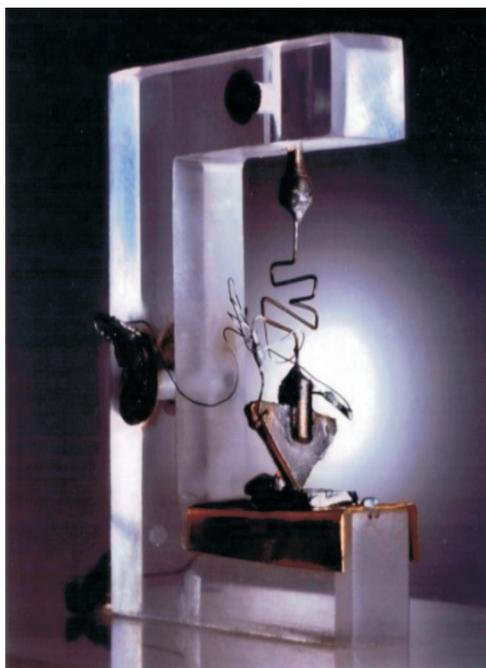
**FIGURA 1.14** – PROTÓTIPO DO PRIMEIRO TRANSISTOR, 1947
