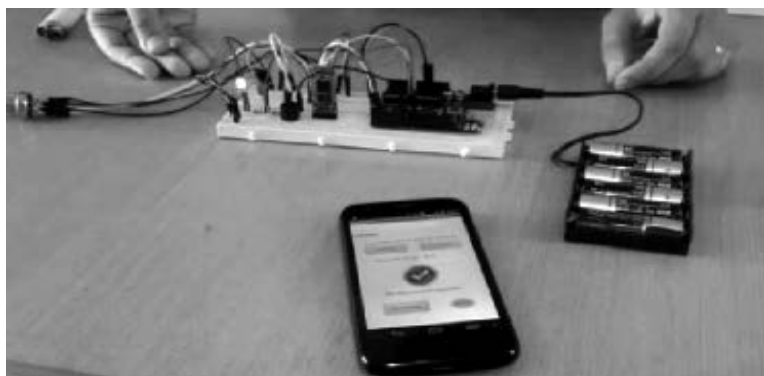
Figura 1 – Sistema de detecção e monitoramento de vazamento de gás em funcionamento.
