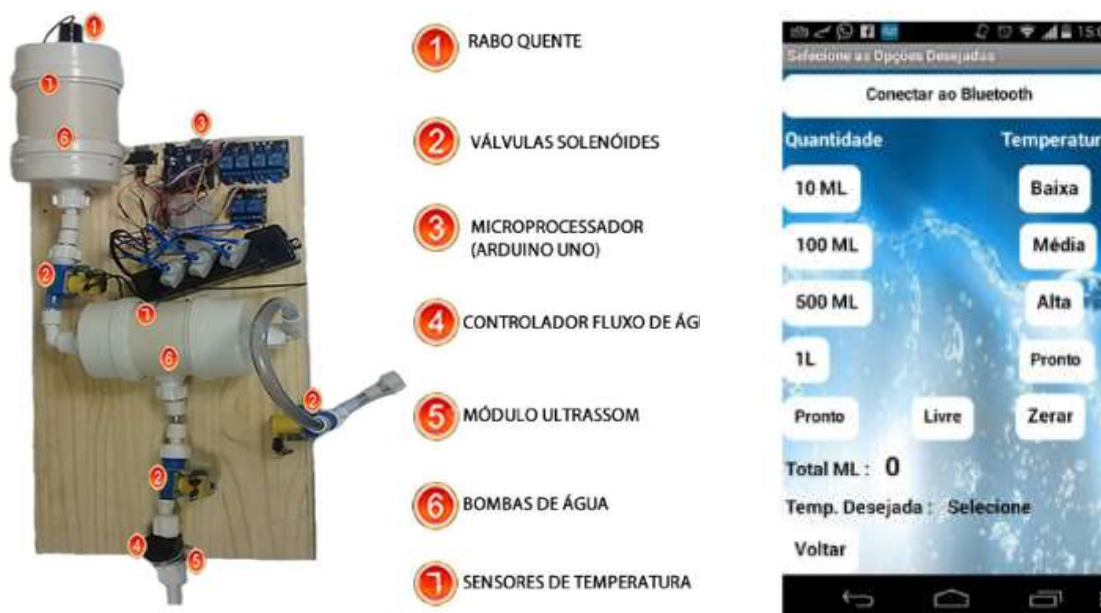
Figura 9. Fotos do sistema misturador automatizado de água (esquerda) e da tela do aplicativo Android (direita)
