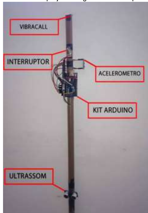
Figura 8 - Foto do projeto bengala eletrônica para cegos
