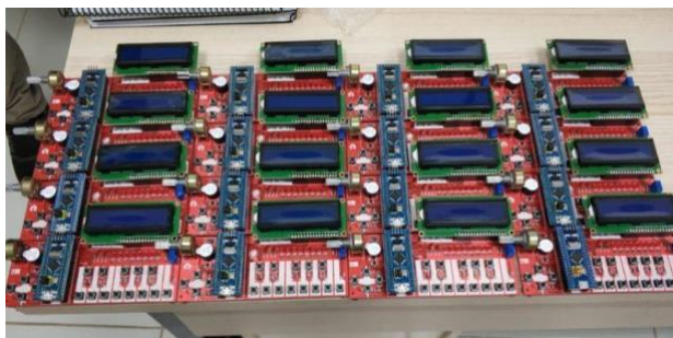
Figura 8 - Kit laboratorial desenvolvido para disciplina de Microcontroladores.
