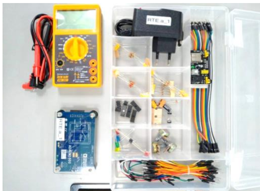
Figura 7 - Kit laboratorial desenvolvido para disciplina de Circuitos e Eletrônica.
